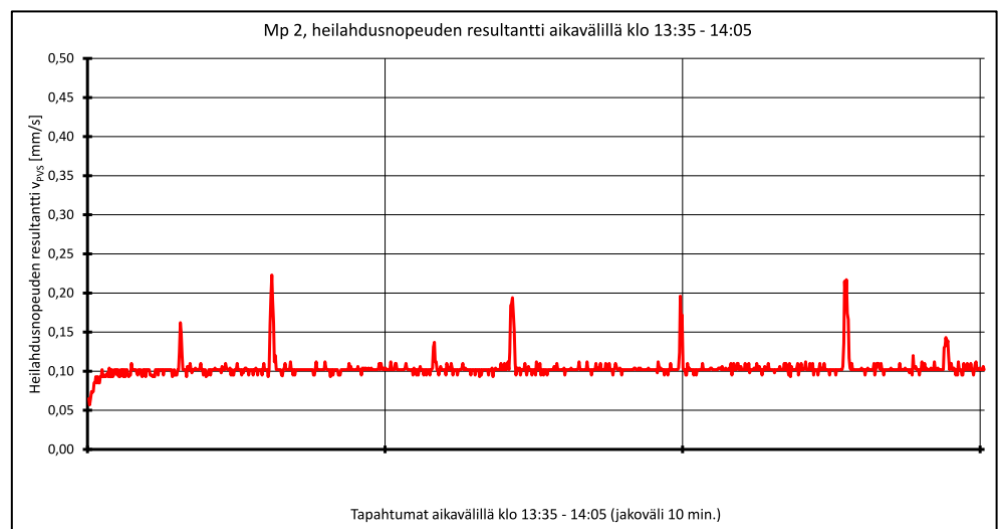
Kuva 4: Heilahdusnopeuden resultantti mittauspisteessä Mp 2 noin 30 minuutin tarkkailujakson aikana. Taustatason ylittävät "piikit" ovat junaohitusten aiheuttamia tärinähavaintoja.
