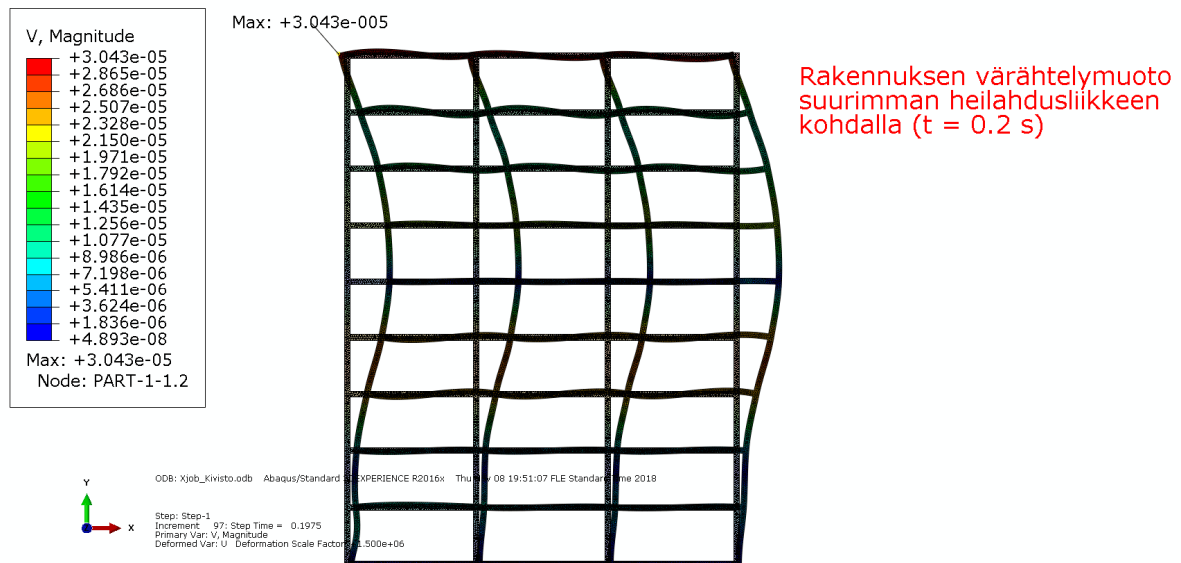
Kuva 7. Rakennuksen kattotason vaakanopeuden heilahdusmuoto ajanhetkellä t = 0.2 s.
