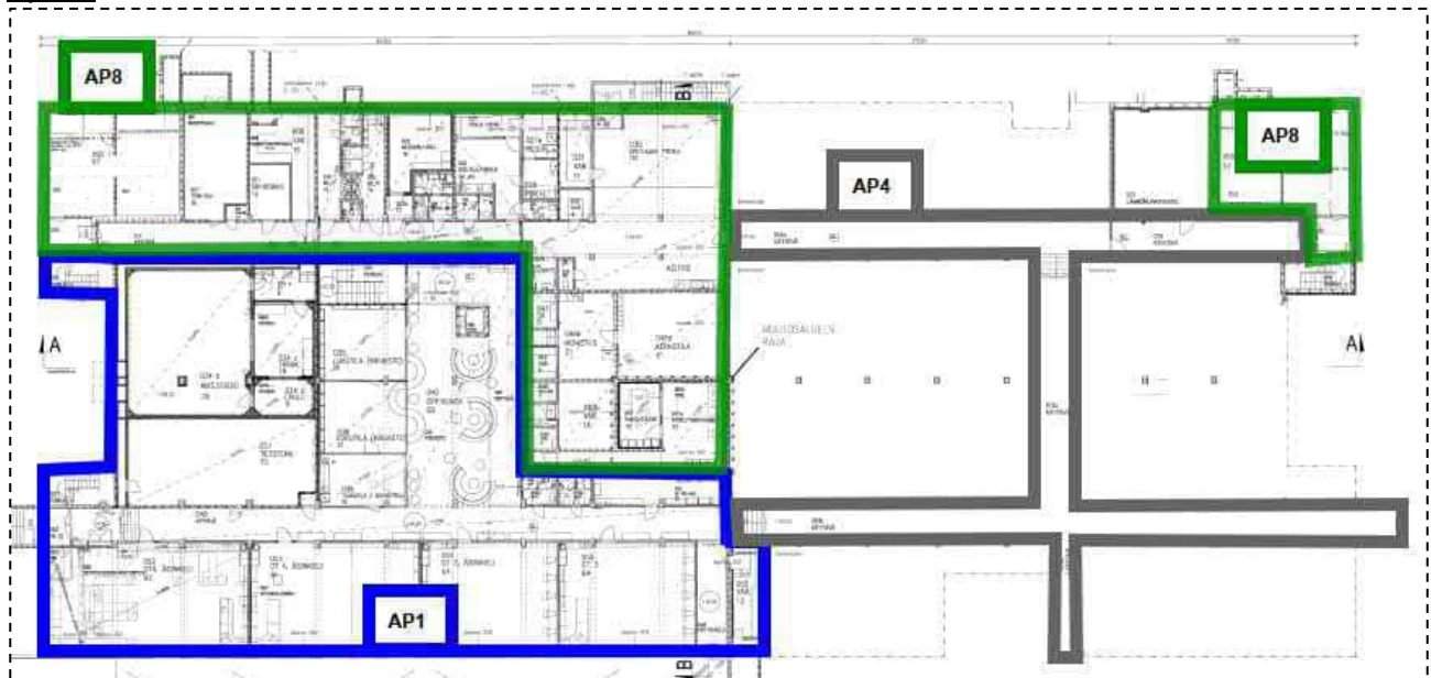
Kuva 42. Päärakennuksen kellarikerroksen alapohjarakenteiden sijainnit.
