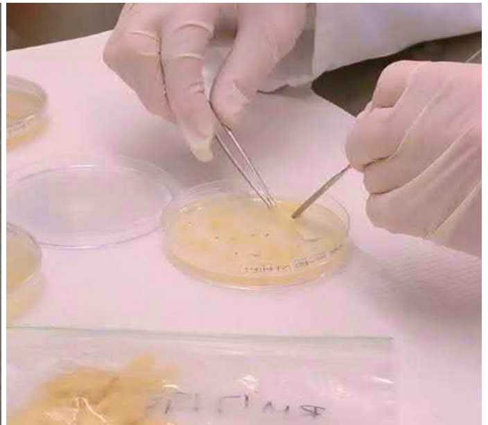
Esimerkkikuva. Oikealla rakennusmateriaalinäytteenotto suoraviljelyanalyysiä varten (FCG Oy). Oikealla suoraviljelyanalyysi laboratoriossa (Mikrobioni Oy).
