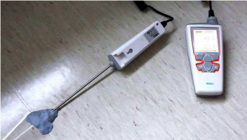
Esimerkkikuva. Viiltokosteusmittauksen toteutus.
