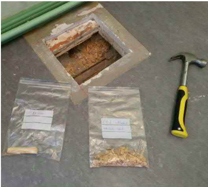
Esimerkkikuva. Oikealla rakennusmateriaalinäytteenotto suoraviljelyanalyysiä varten (FCG Oy). Oikealla suoraviljelyanalyysi laboratoriossa (Mikrobioni Oy).
