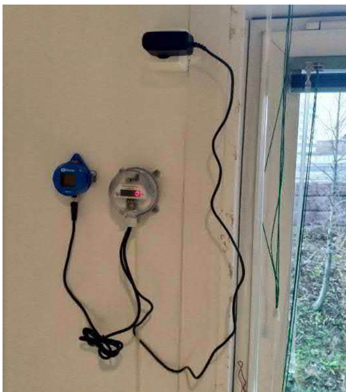
Esimerkkikuva. Jatkuvatoiminen (loggaava) paine-eromittaus (vasen kuva). Hetkellinen paine-eromittaus (oikea kuva).
