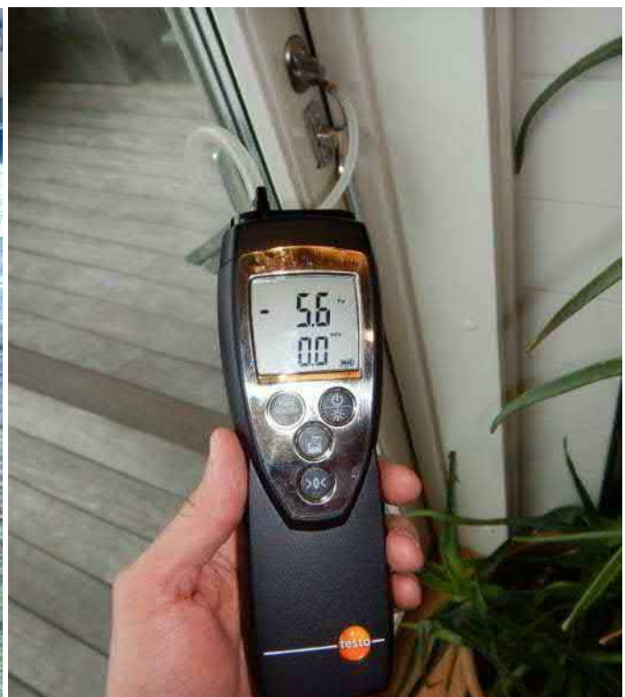
Esimerkkikuva. Jatkuvatoiminen (loggaava) paine-eromittaus (vasen kuva). Hetkellinen paine-eromittaus (oikea kuva).
