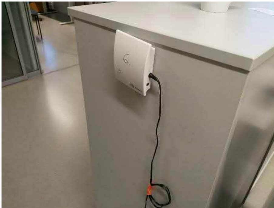
Esimerkkikuva. Sisäilman hiilidioksidipitoisuusmittaus (FCG Oy).
