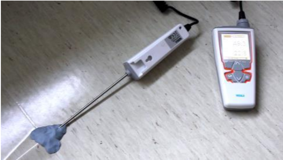
Esimerkkikuva. Viiltokosteusmittauksen toteutus.
