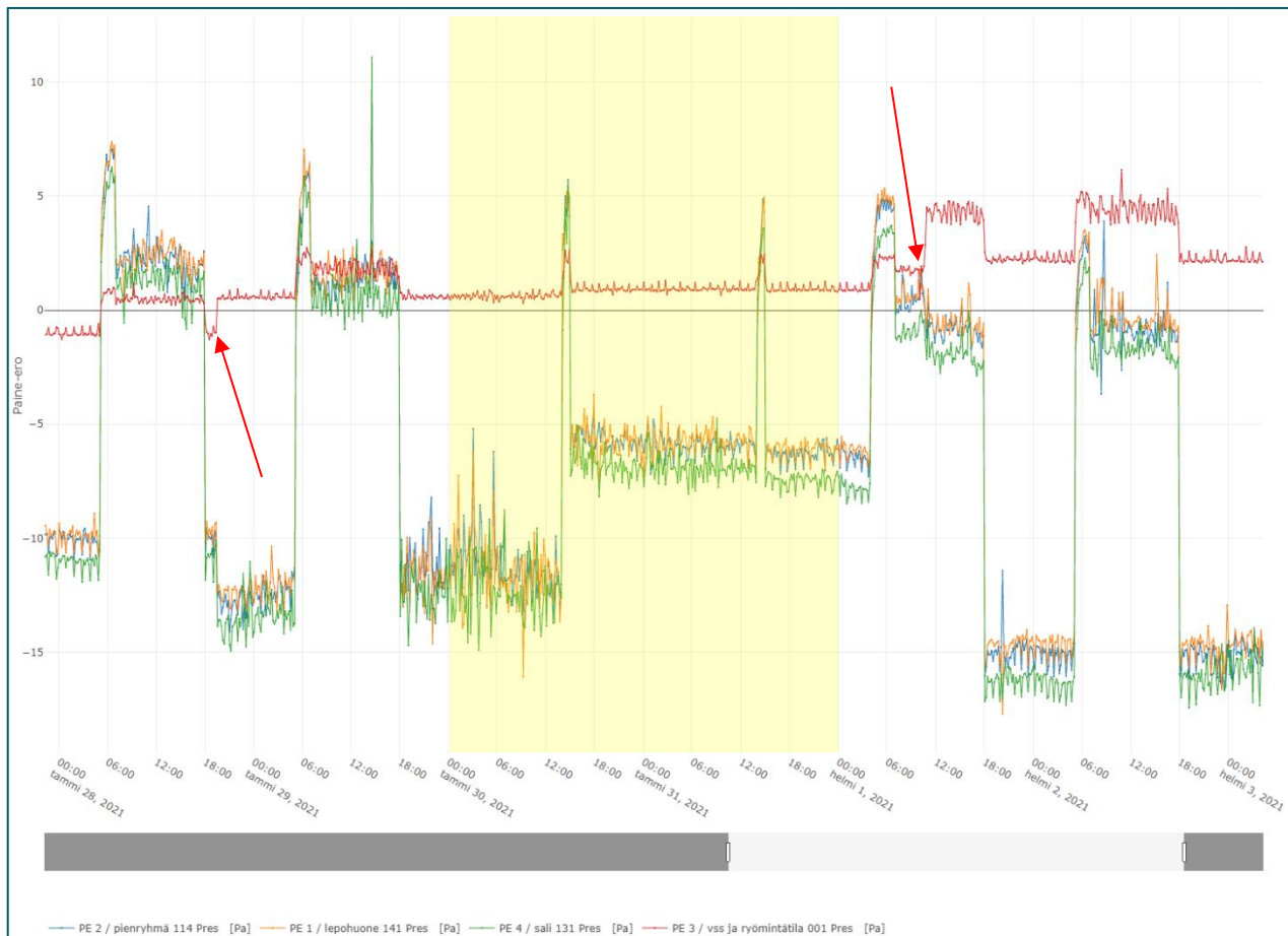
Kuva 98. Alustilan puhaltimien käynnistämisen muodostama paine-eromuutos (punainen nuoli). Viikonloppu (la-su) merkitty keltaisella.
