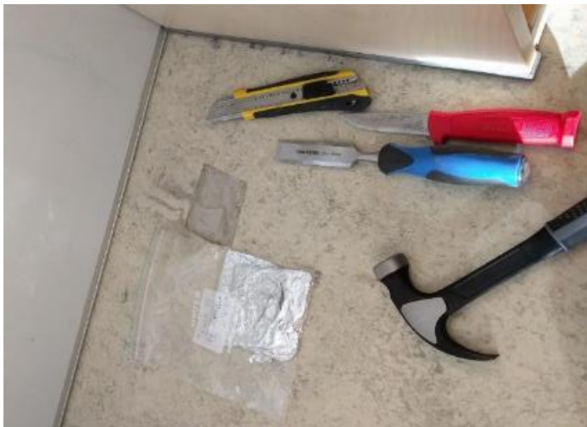
Esimerkkikuva. VOC-BULK-näytteenotto lattiapäällysteestä (FCG Oy)
