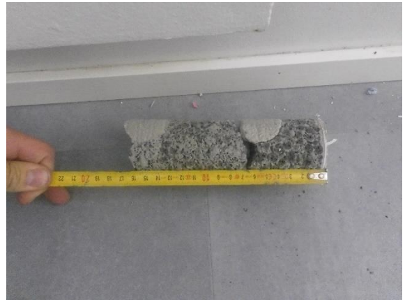
Kuva 24. Ulkoseinärakenne US-4 on kevytsorabetonirunkoinen.
