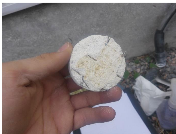
Kuva 6. Rappausverkko on rappauskerroksen sisäpinnassa.
