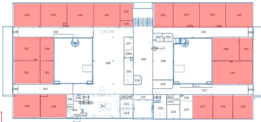
Kuva 28. Toisen kerroksen tiivistyskorjauksen laajuus lähtötietojen mukaan.
