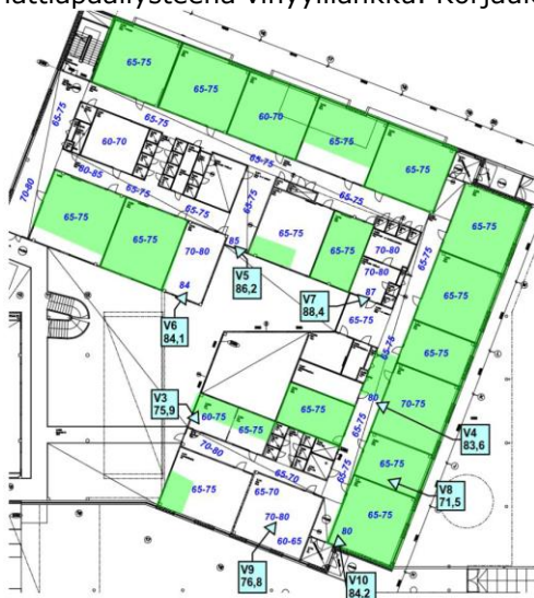
Kuva 2. Viilomittapisteet (V3-V10) ja pintakosteusilmaisimen lukemat toisen kerroksen osapohjapiirustuksessa. Vihreällä taustaväriä on esitetty Vahanen Oy:n 2014 suunnitelmien mukaan kapselointikorjauksella 2014 korjatut alueet. Mittauksissa merkittynä myös mitatut suhteellisen kosteuspitoisuuden arvot.
