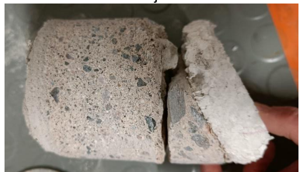
Kuva 14 Betonirakenteen alla on EPS-eriste 25 mm.
