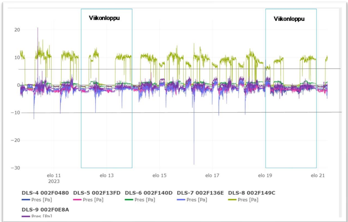
Kuva 181. Painesuhteet ulkoilmaan nähden pohjakerroksen tiloissa sekä liikuntasalista käytävälle B202 (DLS-8).
