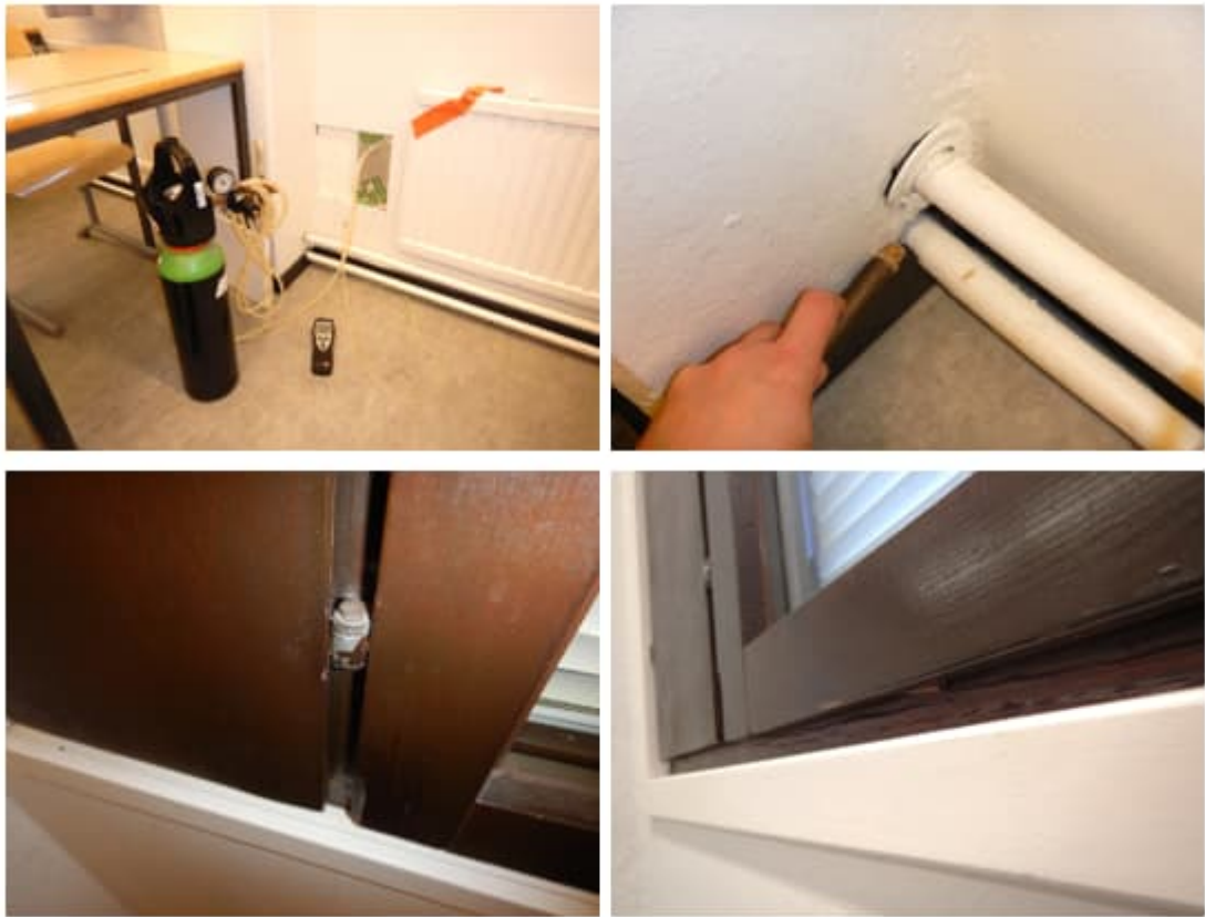
Kuva 68. a-d. Merkkiainekoe MK6, tila 2047, paine-ero -11...-18 Pa.
