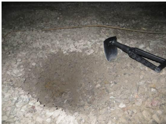
Kuvat 2a ja 2b. Koekuoppa ryhmätala 1075 alla, syvyys n. 370 mm. Kaivukohdalla kosteaa murskettä, lisäksi hienoa hiekkaa, pohjalla on musta suodatinkangas. Oikealla koekuoppa liikuntasali 1004 alla, jossa ensin sepeliä # 6–16 mm ja sitten kosteaa murskettä, jonka alla on hienoa hiekkaa.
