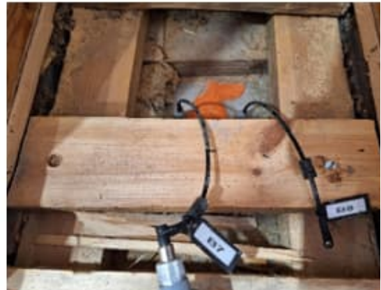
Kuva 28. a-b. Porareikämittaukset liikuntasalin alapohjaan. Mittapisteet alapohjaan (B7: 67,6 %RH ja B8: 69,2 %RH)
