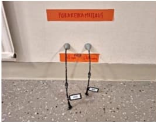
Kuva 27. a-b. Porareikämittaukset käytävän 011 vastaisesta maanpaineseinästä. Mittapisteet tehtiin seinän alaosaan (B2: 53,4 %RH ja B3: 64,8 %RH) ja keskivaiheille (B4: 45,8 %RH ja B5: 51,4 %RH).
