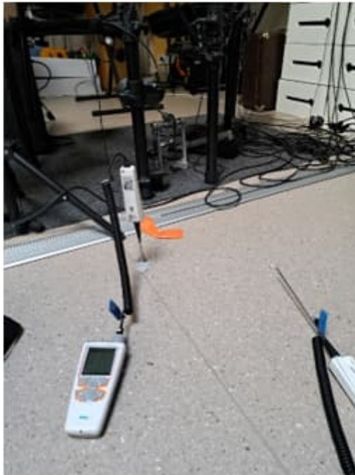
Kuva 61. a-b. Hetkelliset kosteusmittaukset tilan 127 [REDACTED] [REDACTED] välipohjan hiekkatäytöstä.
