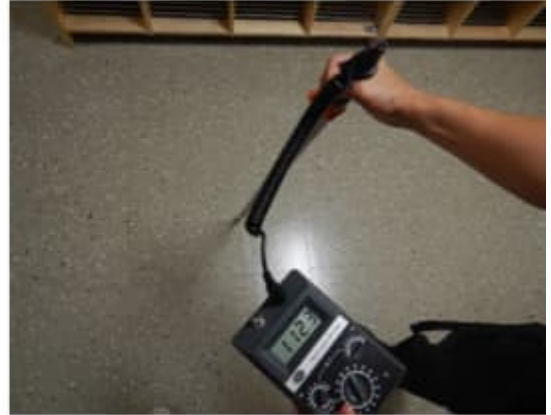
Kuva 19. a-b. Pohjakerroksen kvartsivinyylilaatta pinnoitteet olivat havaintojen mukaan siistit. Kohonneita vertailuarvoja havaittiin pintakosteusilmaisimella vain paikallisesti käytävän osalta (90–115).
