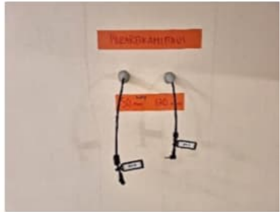
Kuva 27. a-b. Porareikämittaukset käytävän 011 vastaisesta maanpaineseinästä. Mittapisteet tehtiin seinän alaosaan (B2: 53,4 %RH ja B3: 64,8 %RH) ja keskivaiheille (B4: 45,8 %RH ja B5: 51,4 %RH).
