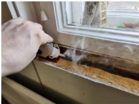
Kuva 29. Tilojen 101–103 p sekä 108–113 p ulkoseiniin on asennettu lisäkoolaus 50 mm ja maalattu lastulevy. Ikkunalaudan takaa havaittiin voimakas ilmavirta tilaan, sekä välissä pölyä ja likaa. Ilmavirran mukana oli aistittavissa voimakas puukuuti- ja lastulevyn epämiellyttävä haju.
