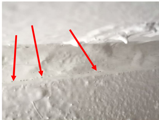
Kuva 42 a-c. Tilan 115 ulkoseinään tehdyssä merkkiainekokeessa havaitut paikalliset vuotokohdat esitetty punaisiin nuolin ja lähikuvat vuotokohdista. Kaasun syöttöpaikka merkattu sinisellä.
