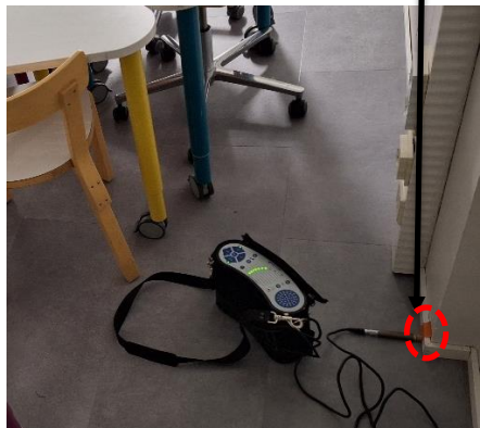
Selviä vuotoja alapohjan ja väliseinän liittymässä neljässä pisteessä.
