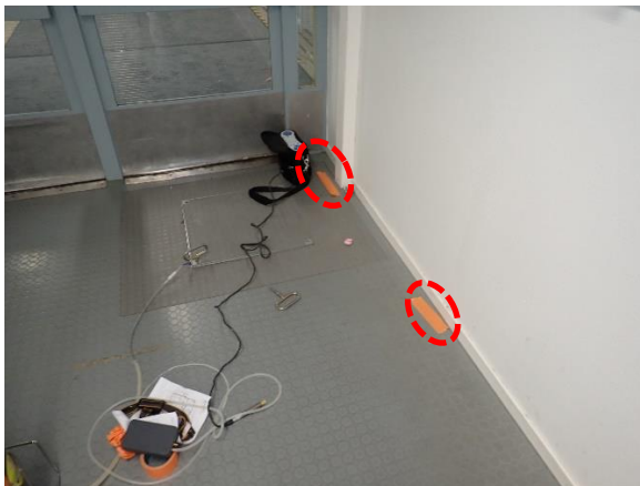
Kuva 46 Merkkiainekokeissa todettiin, että tekniikkakanaalista on ilmavuotoja sisätiloihin päin normaalitilanteessa.
