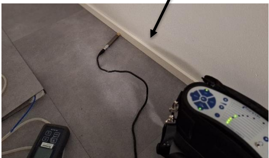
Selvää vuotoa alapohjan ja ulkoseinän rakenneliittymässä lähellä syöttöpistettä.
