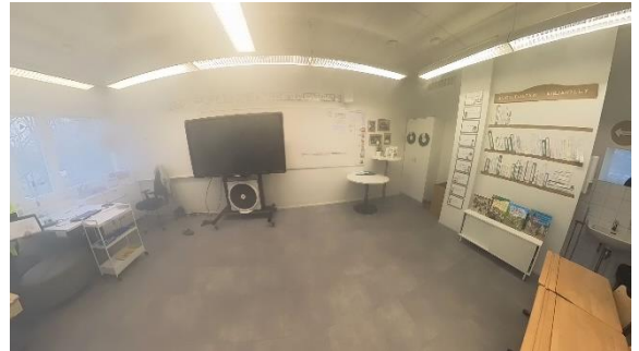
Kuva 106 Luokassa 204 savu jäi verrattain pitkäksi ajaksi ikkunaseinälle ja jakaantui hitaasti oviseinälle.
