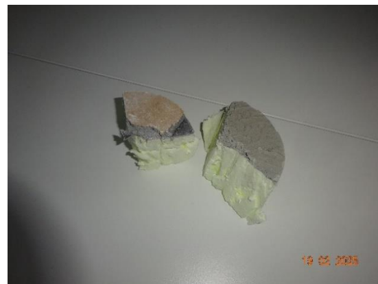
Kuva 2. Uretaanilevyn pinnassa ollut kipsilevy oli kiinnitetty laastilla uretaanilevyyn.
