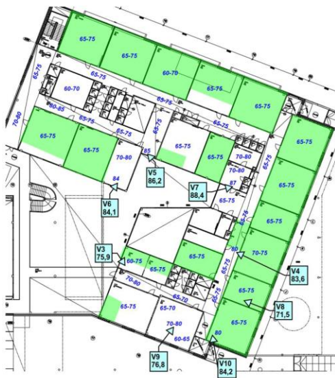
Kuva 2. Viiltoimittapisteet (V3-V10) ja pintakosteusilmaisimen lukemat toisen kerroksen osapohjapiirustuksessa. Vihreällä taustaväriä on esittelly Vahanen Oy:n 2014 suunnitelmien mukaan kapselointikorjauksella 2014 korjatut alueet. Mittauksissa merkittynä myös mitatut suhteellisen kosteuspitoisuuden arvot.
