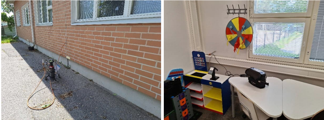
Kuva 30. Ulkoseinän merkkiainetutkimuksissa merkkiainetta laskettiin ulkoseinän eristetilaan elementtisaumojen kautta. Merkkiainevuodot havainnoitiin sisätilojen puolelta.
