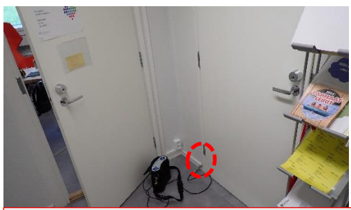
Vuotoa havaittiin myös tilan 224 ulkopuolella käytävän oviliittymässä
