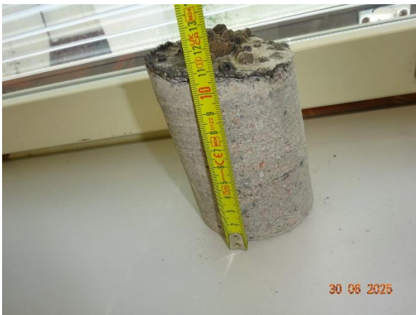
Kuva 1. Pintabetonilaatan porauslieriö, jonka pinnalla on suodatinkangas ja hie-man kevytsoraa.
