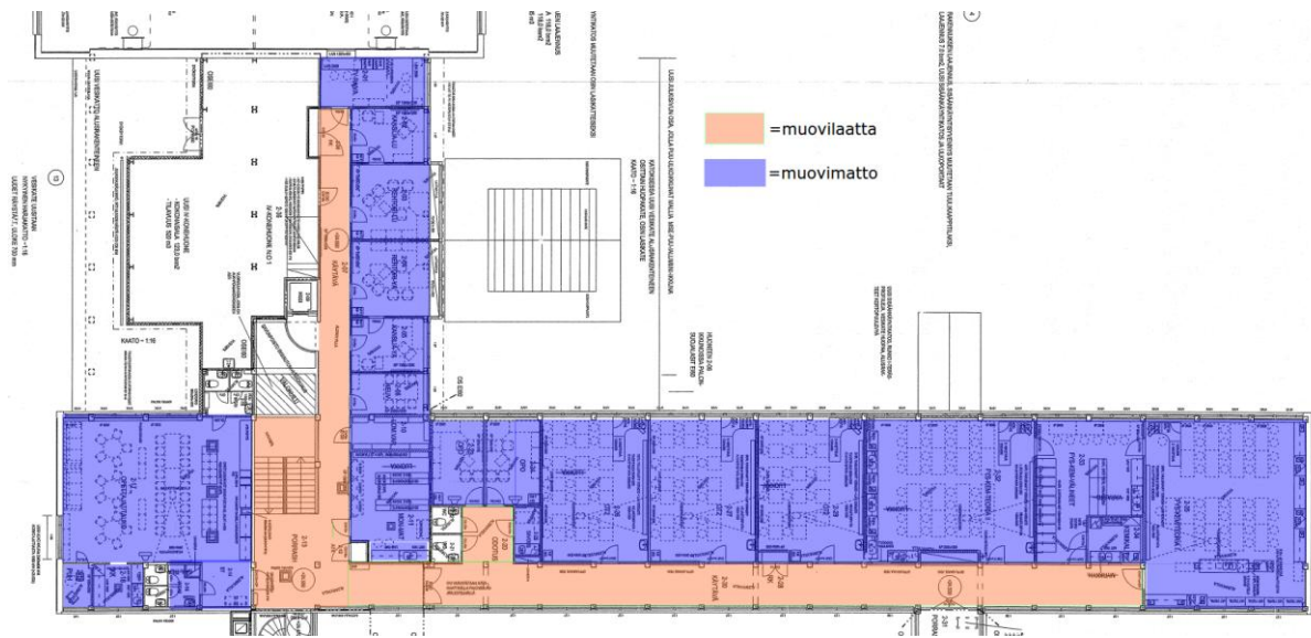
Kuva 6. Toisen kerroksen lattiapäällysteiden sijainnit esitettyinä pohjapiirroksessa.
