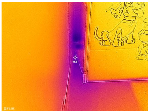
Kuva 14 Tilan 150 sänkykaapin takana oli 19,5 °C.
