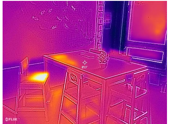
Kuva 21 Tilan 209 lämpökuva, oleskelukohdan lämpötila oli 21,1 °C.
