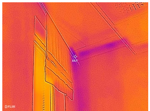
Kuva 25 Tilan 211 kulmauksen lämpötila oli 23,7 °C. Tilan pistemäiset lämpötilat olivat välillä 23...25 °C.
