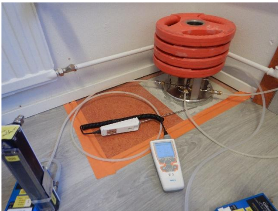
Kuva 51 FLEC-näytteenottopiste tilassa H51, josta on poistettu vinyyilankku, lattiamatto ja tasoite 3 vrk ennen näytteenottoa.
