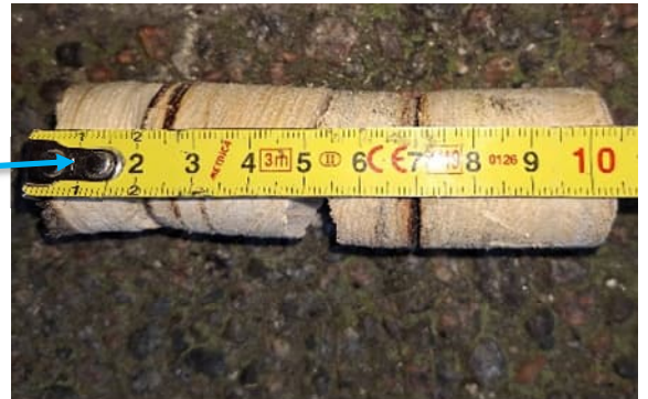
Kuva 58 US-L2, alaohjauspuu on 100 mm paksu.
