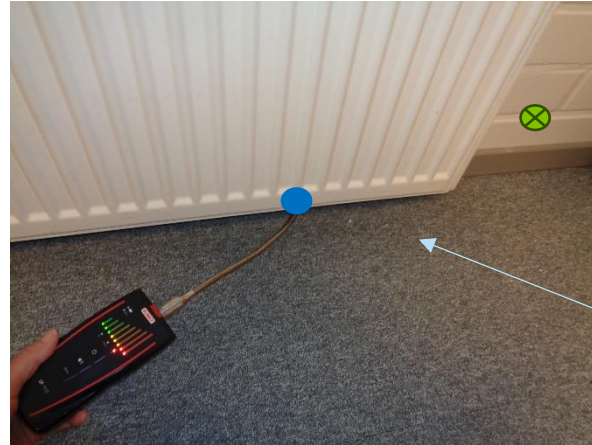
2. Patterinkannakkeen kohdalla havaittiin pistemäistä ilmavuotoa.
