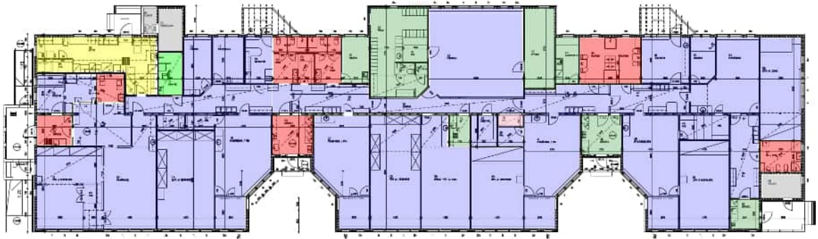
Kuva 5.1. Alapohjan lattianpäällysteiden paikannuskuva. Vinyylilaatta on merkitty sinisellä, keraaminen laatta punaisella, muovimatot vihreällä, keittiön massalattia keltaisella ja maalattu betoni harmaalla värillä. Sähköpääkeskuksen (vaaleanpunainen väri) lattianpäällysteestä ei ole tietoa.
