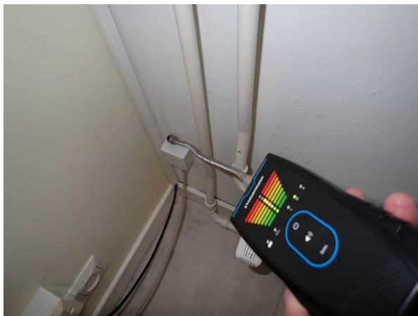
5. Datapistorasiasta todettiin merkittävää pistemäistä ilmavuotoa sekä normaaleissa käyttöolosuhteissa että alipaineistettuna.
