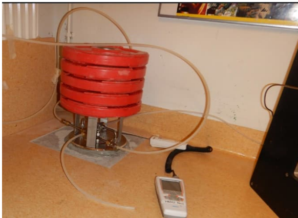
Kuva 32 FLEC-näytteenottopiste [redacted] verstaasta FLEC1, josta on poistettu muovimatto ja tasoite 3 vrk ennen näyt- teenottoa.
