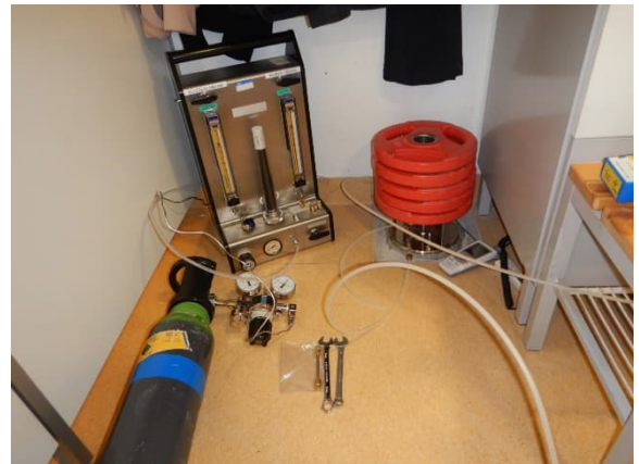
Kuva 33 FLEC-näytteenottopiste [redacted] naisten pukuhuoneesta FLEC2, josta on poistettu muovimatto ja tasoite 3 vrk ennen näytteenottoa.
