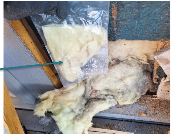
Kuva 42 US7, eristenäyte LN3 otettiin eristeen sisäpinnasta.
