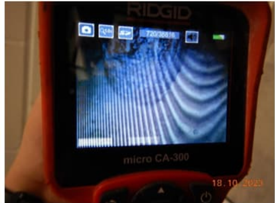
Kuva 88 a-b. F2 Karuna 2117, tekniikkakuiluun tehtiin rakenneporaus, jonka tarkastettiin kuilun sisäpuoli. Kuilussa ei havaittu sinne kuulumatonta jätettä. IV-kanavan läpivienti välipohjaan oli valettu.
