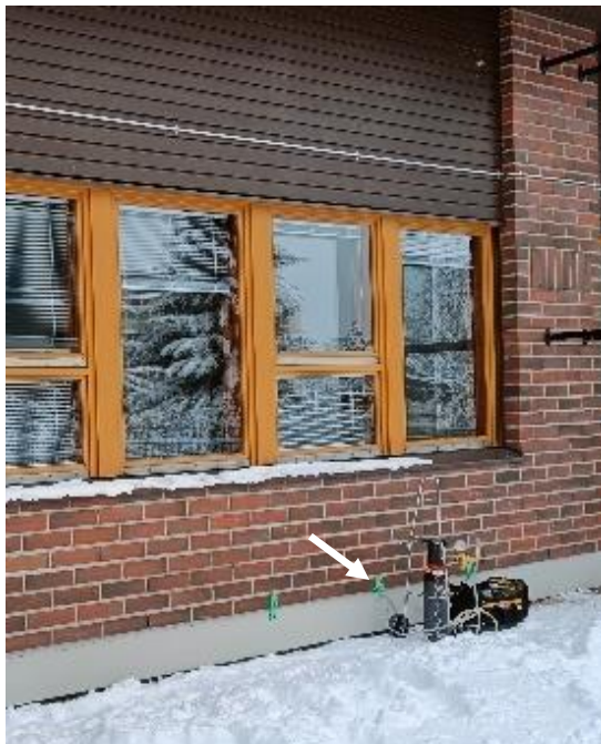
Kuva 83 MA8, Liikuntasali 21. Merkkiaine syötettiin ulkoseinän alaosaan tuuletusraon kautta.
