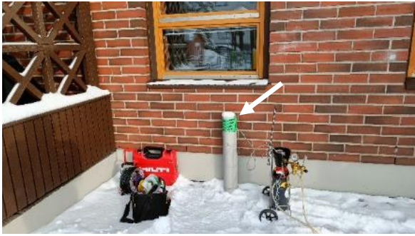
Kuva 20 MA1, pienryhmä 15. Merkkiaine syötettiin alapohjatilaan tuuletuspaalun kautta.
