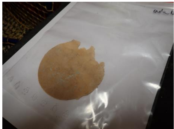
Materiaalinäyte MA.16-US otettiin polyuretaanilevystä irti poratun näytekappaleen sisäpinnan kartonkilaaminaatista, jossa oli havaittavissa kosteusrasitukseen viittaavaa värjäytymää, mutta ei silmin tunnistettavaa mikrobikasvua.
