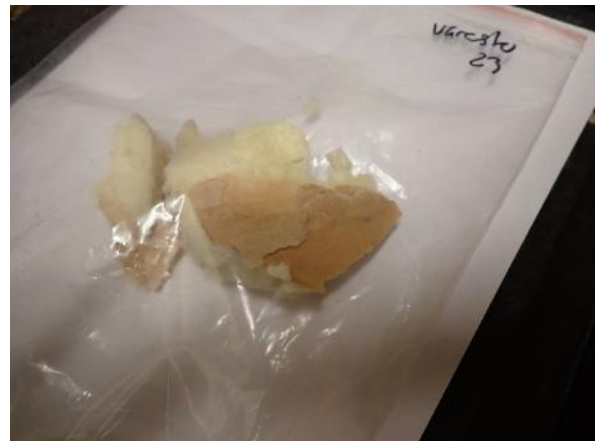
Materiaalinäyte MA.25-US otettiin polyuretaanilevystä irti poratun näytekappaleen sisäpinnan kartonkilaaminaatista, jossa oli kosteusrasitukseen viittaavaa värjäytymää.
