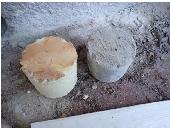
Sokkelihalkaisun ulko- ja sisäpinnassa olevassa kartongissa oli havaittavissa kosteusrasitukseen viittaavaa värjäytymää, mutta ei silmin tunnistettavaa mikrobikasvua.
