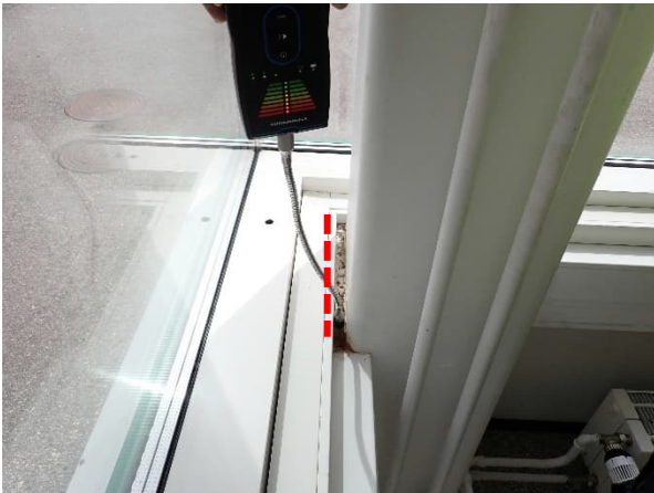
4. Pilarin ja ulkoseinän välisestä raosta todettiin merkittävää laaja-alaista ilmavuotoa normaaleissa käyttöolosuhteissa ja alipaineistettuna.
