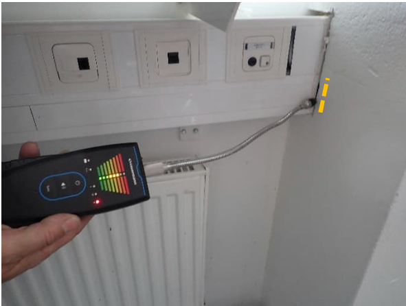
4. Koteloidun pilarin ja sähkökourun välisestä raosta havaittiin vähäistä rakomaista ilmavuotoa normaaleissa käyttöolosuhteissa ja alipaineistettuna.
