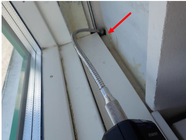
4. Koteloidun pilarin ja ulkoseinän liittymästä todettiin merkittävää pistemäistä ilmavuotoa tilan ollessa alipaineistettuna.
