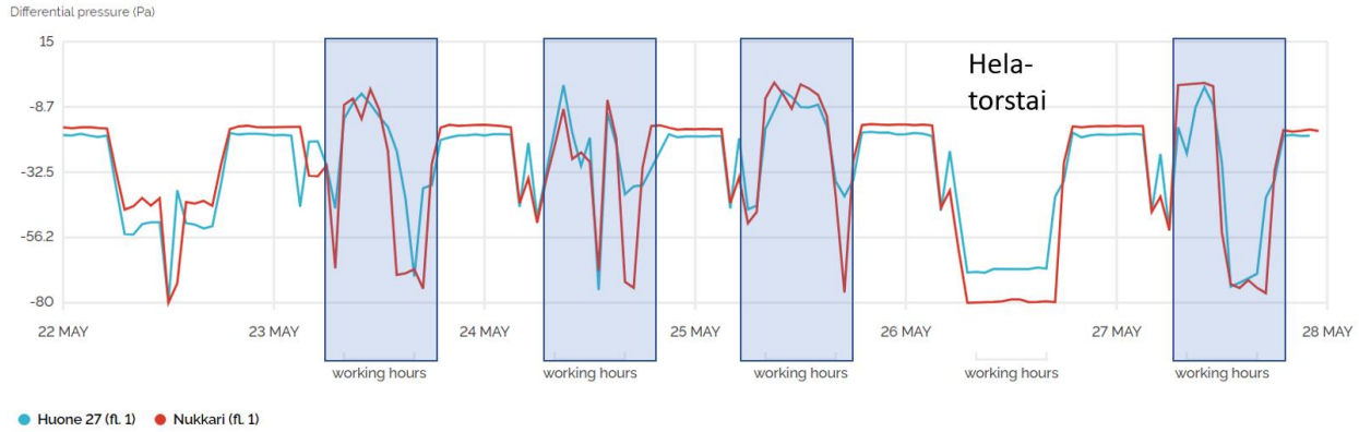
Kuva 1. Paine-eromittausten mukaan päiväkodin ilmanvaihto ei ole tasapainossa. Kuvaajassa virka-aika on korostettu sinisellä värillä.
