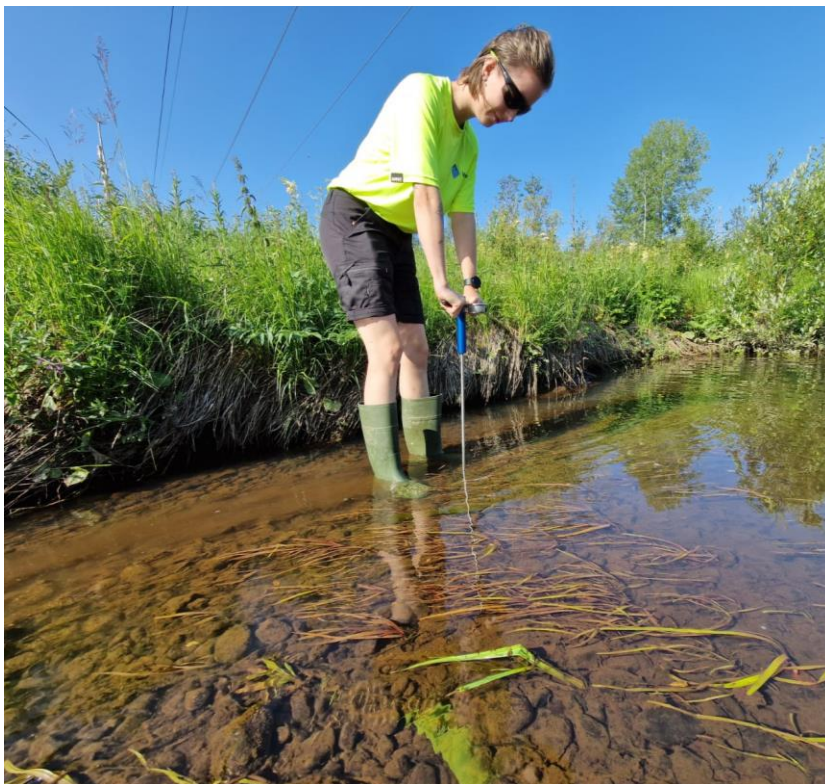
Kuva 12. Suninen mittaamassa sorapatjan paksuutta ja kuohkeutta penetrometrillä (Tiusanen, 2023).
