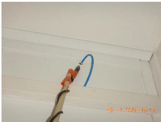
Kuva 52. Tilan 105 ilmavuotokohtia: ulkoseinälevytykseen porattu läpivienti, seinänurkka paikallisesti.
