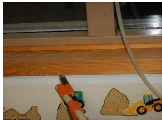
Kuva 49. Tilan 105 ilmavuotokohtia: ikkunaelementin liitokset paikallisesti.
