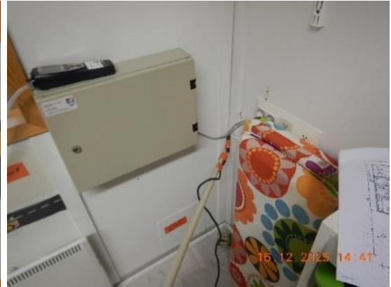
Kuva 50. Tilan 105 ilmavuotokohtia: ulkoseinän liitokset paikallisesti.
