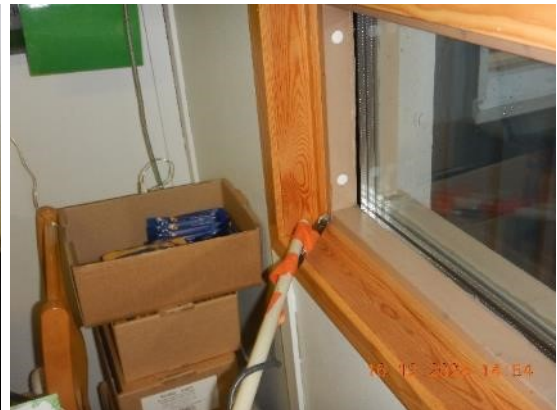
Kuva 48. Keittiön 101 ilmavuotokohtia: patterikiinnikkeiden kohdat, ikkunaelementin nurkat.
