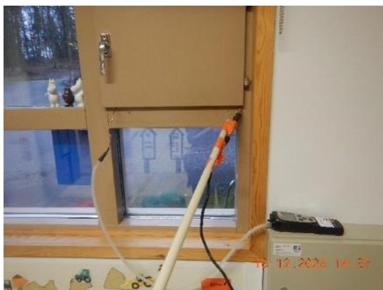
Kuva 49. Tilan 105 ilmavuotokohtia: ikkunaelementin liitokset paikallisesti.
