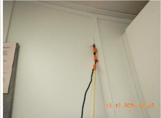
Kuva 47. Keittiön 101 ilmavuotokohtia: levysauma paikallisesti, seinässä olevan peitelevyn reuna.
