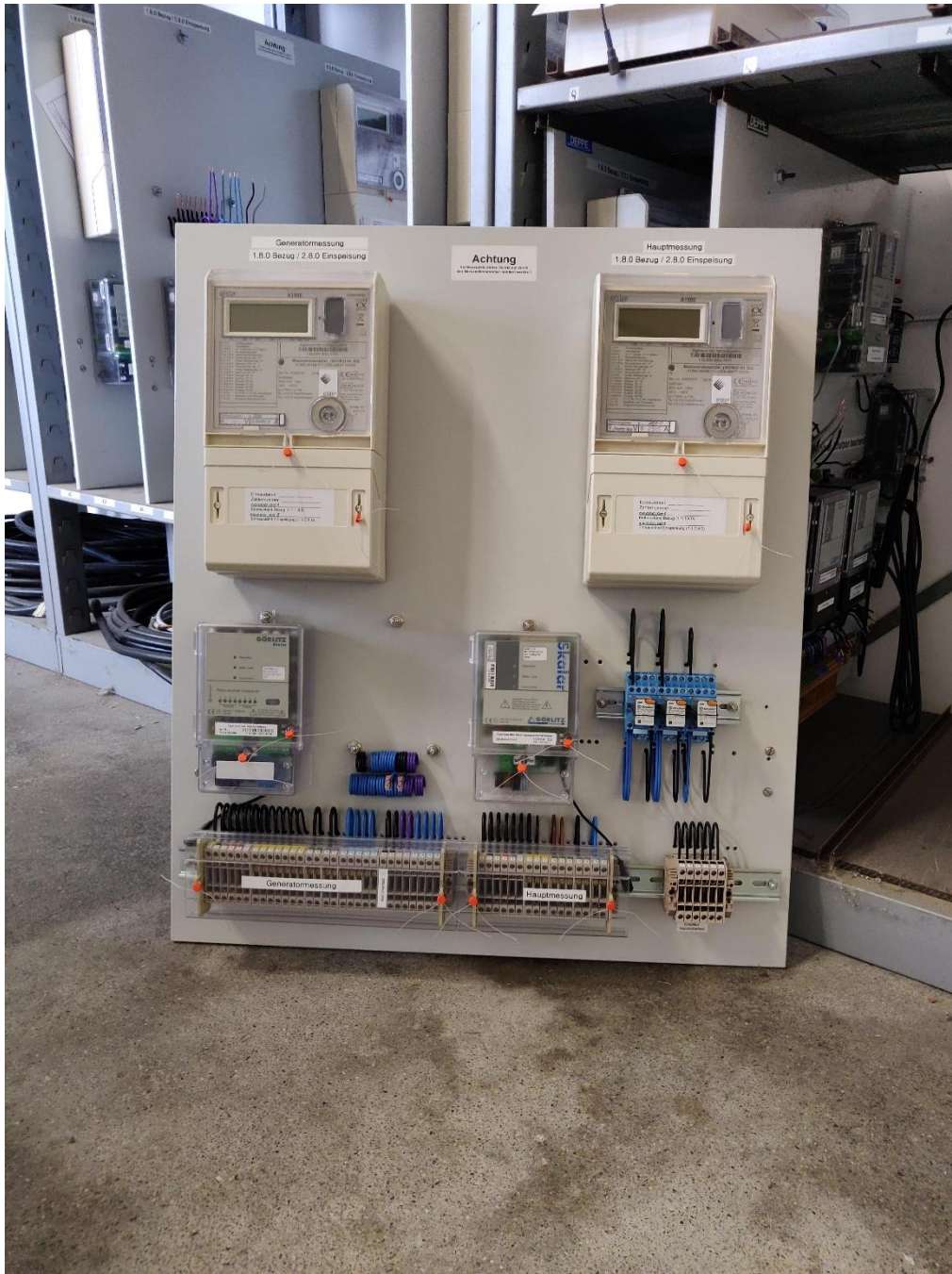
Kohteeseen asentamista vaille valmis mittaristo
