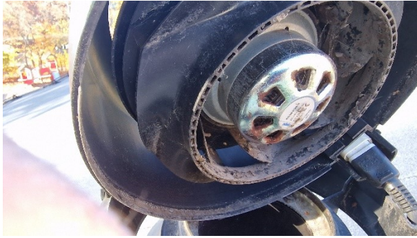
Kuva 80. Yleiskuva radonpoiston talotuulettimesta, joka on epäkunnossa
