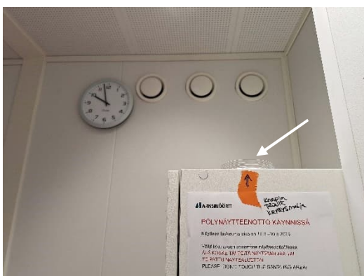
Kuva 5 Näytteet MK2.1 ja PK2 eteisaulan paloetkukaapin päältä. Näytteessä MK2.1 ylittyi kuitumäärä, jotka olivat vuorivillatyypisiä kuituja.
