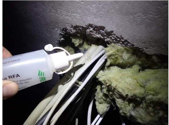
Kuvat 33 a ja b. Ryömintätilasta yläpuolisten tilojen suuntaan havaittiin ilmavirtausta muutamien läpivientien kohdilla.
