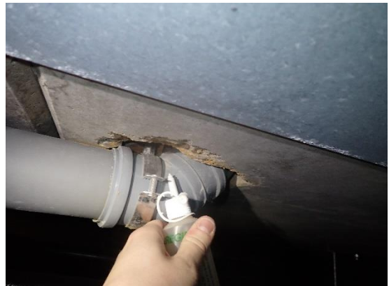
Kuvat 44 a ja b. Alapohjarakenteen läpivienneistä ei havaittu merkkisavun avulla selkeitä ilmapirtauksia sisäilmaan päin.
