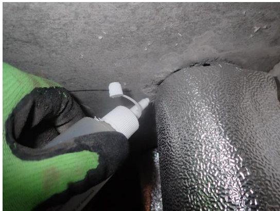
Kuvat 44 a ja b. Alapohjarakenteen läpivienneistä ei havaittu merkkisavun avulla selkeitä ilmapirtauksia sisäilmaan päin.
