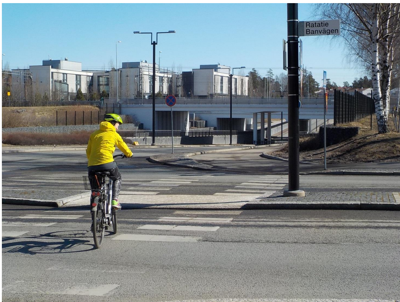
Kuva 3. Pyöräilyn sujuvuutta edistetään monin keinoin, esimerkiksi kaupungin uusien suunnitteluohjeiden mukaan pyörätien jatkeella ei enää käytetä reunakiveä. Kuva Vantaan kaupunki/ Timo Väistö
