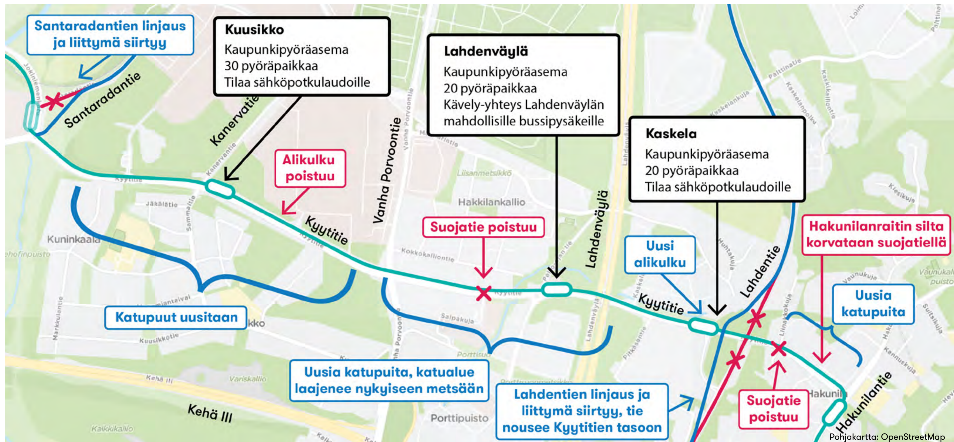
Kuva 4.15 Ratikan linjaus Kyytitiellä ja ratikan mukana tehtäviä muutoksia katu ympäristöön.
