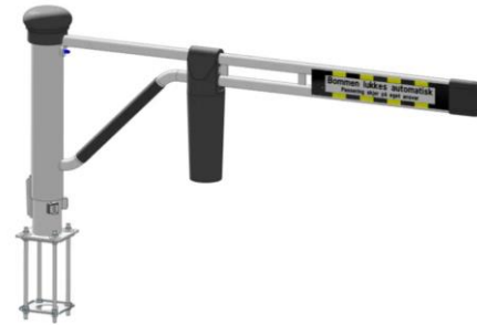
Avattava ajoeste: Autogate-puomi (Elpac), pit. 2-3 m, kork. 1,3 m. Varustetaan heijastimin
