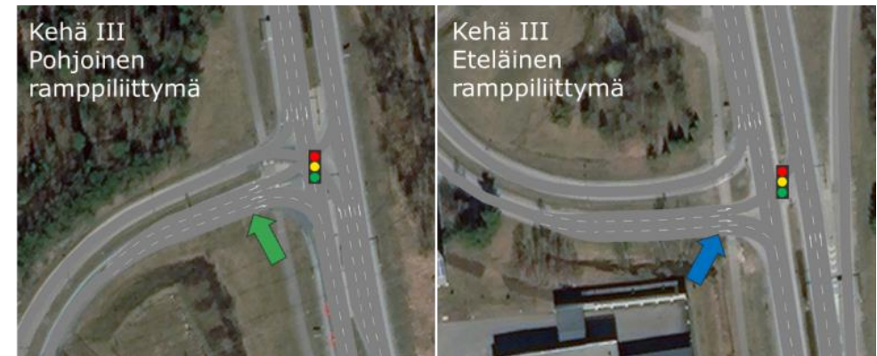
Kehä III:n ramppiliittymien lisäkaistat.
