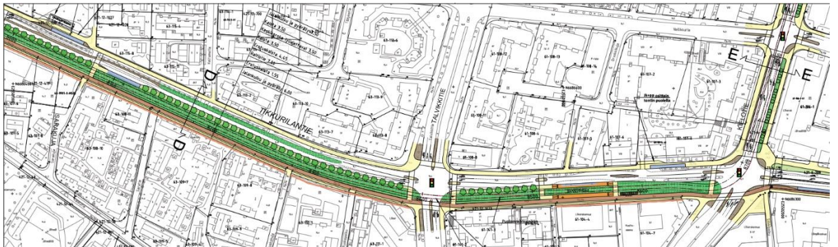
Kuva 17. Ote Vantaan ratikan yleissuunnitelmasta Tikkurilantiellä ja Kielotieellä (WSP Finland 2019). Silkkitehtaan raitiotien pysäkki on merkitty oranssilla ja bussipysäkit sinisellä.
