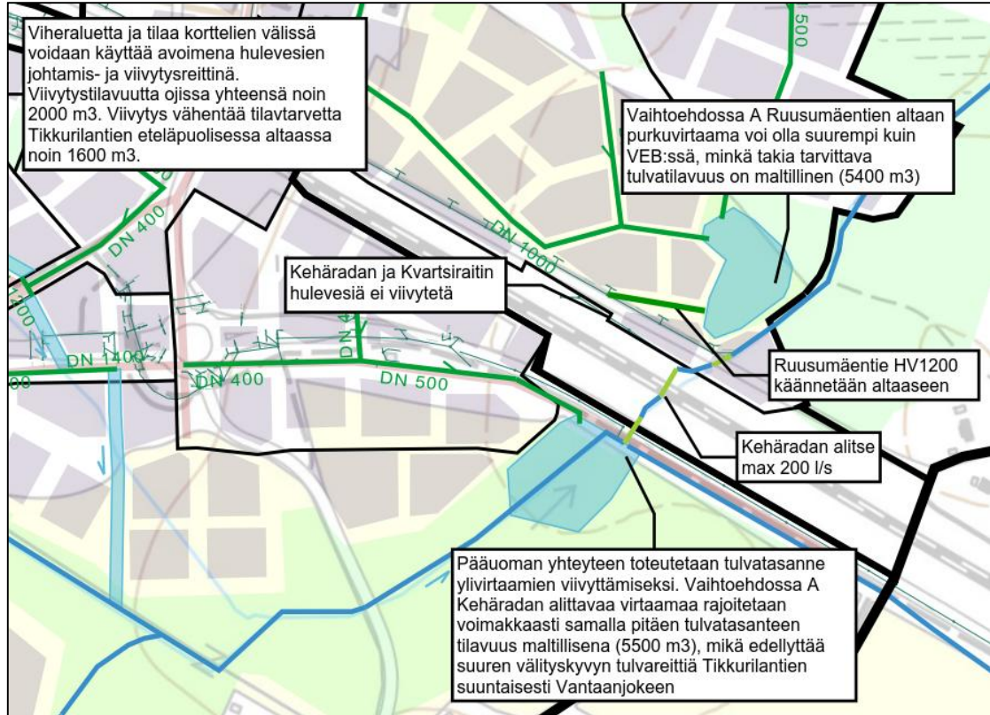
Kuva 9. Hulevesien hallinnan vaihtoehto A.
