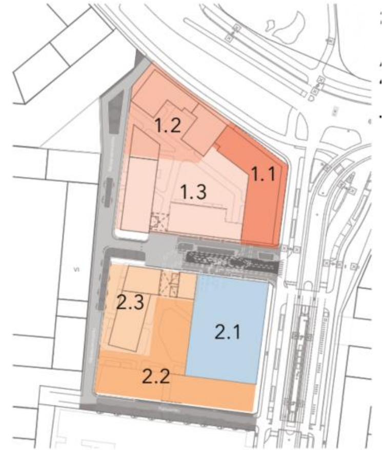
Kuva. Rakentamisen vaiheistus (Arco Architecture Company, 19.9.2025)
