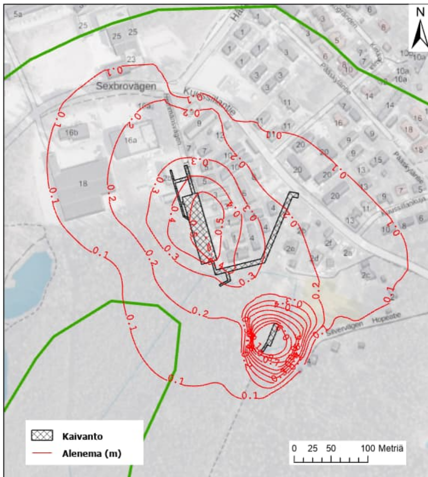
Kuva 11. Pohjaveden tason muutos (alenema metreinä) 60 vuorokauden kuluttua kaivantojen kuivatuksen aloittamisesta (Taustakartta ja ortoilmakuva: Maanmittauslaitos 2025).
