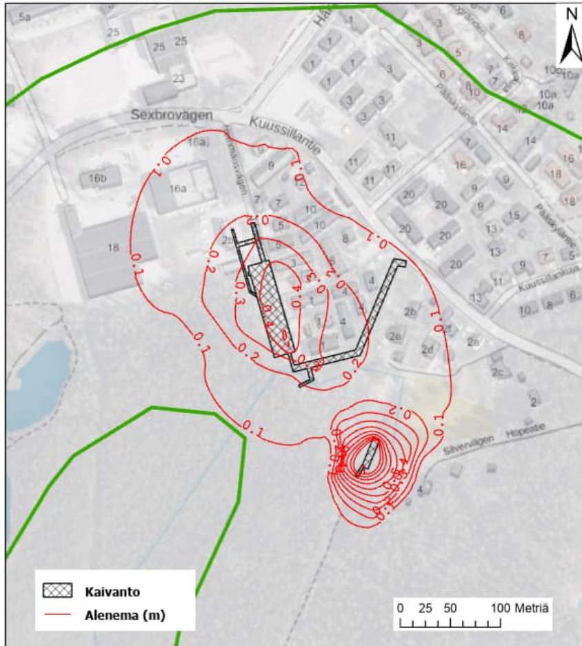
Kuva 10. Pohjaveden tason muutos (alenema metreinä) 30 vuorokauden kuluttua kaivantojen kuivatuksen aloittamisesta (Taustakartta ja ortoilmakuva: Maanmittauslaitos 2025).
